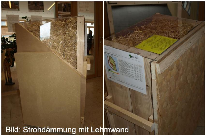
Bild: Strohdämmung mit Lehmwand
