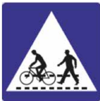
53/2c Kennzeichnung eines Schutzweges und einer Radfahrerüberfahrt (gemeinsam genutzt)
